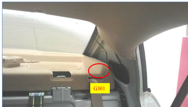
G301 位于左后 C 柱下方的安全带处。
